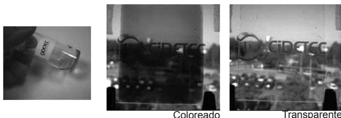
Figura 1 Formulación electrocrómica sintetizada en CIDETEC (izquierda) y dispositivo electrocrómico sobre sustrato cristal preparado a partir de la formulación (derecha).
